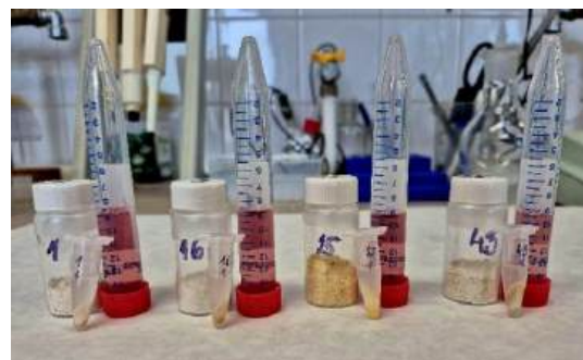
Obr. 2 Ukážka pomletých vzoriek zľava pšenice, jačmeňa, kukurice a bôbu, ich centrifugovaných extraktov v eppendorfkách a zmiešaných extraktov s Wadeovým činidlom v skúmavkách.
