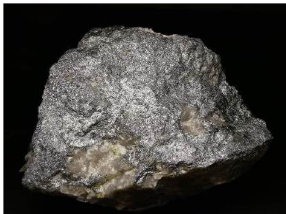
Obr. 5 Oloveno-sivé agregáty bournonitu v kremennej žilovine. Rozmery záberu sú 12 x 9 cm. Foto: [Marek Ratkovský]
