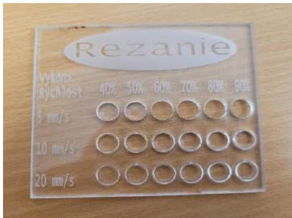
Obr. 6 Hotová vzorka „rezanie“ vypracovaná na akryl
