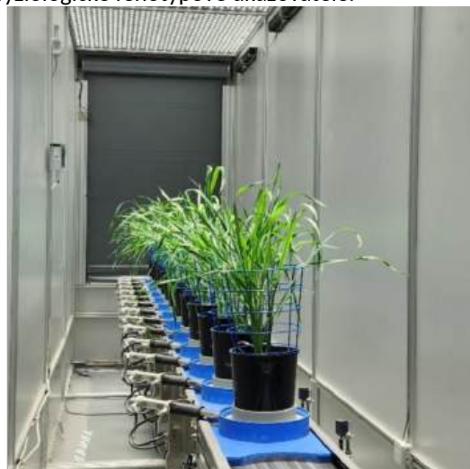
Obr. 1 Rastliny pšenice ( Triticum durum ) pestované v črepníkoch umiestnených na automatizovanej dopravníkovej fenotypovacej linke. Zdroj: PSI Photon System Instruments s.r.o, Drásov, ČR.
