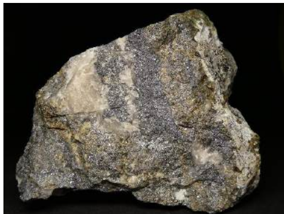
Obr. 12 Sfalerit (hnedožltý) v asociácii s galenitom (tmavšie sivý) a bournonitom (svetlosivý) v kmeni. Veľkosť vzorky je 10 x 9 cm. Foto: [Marek Ratkovský]
