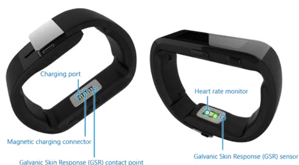
Obr. 1 GSR a HRV senzor. Zdroj: [18]
