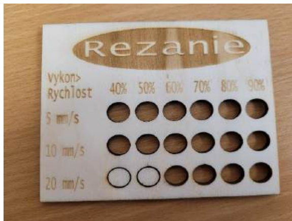
Obr. 4 Hotová vzorka „rezanie“ vypracovaná na preglejke.
