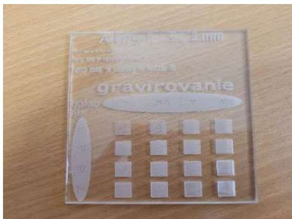
Obr. 5 Hotová vzorka „gravírovanie“ vypracovaná na akryl.
