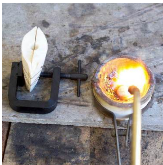
Obrázok 6 Roztavený kov prichystaný na odlievanie
