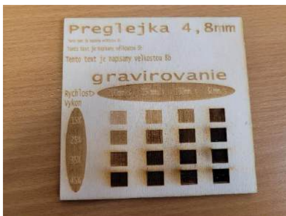
Obr. 3 Hotová vzorka „gravírovanie“ vypracovaná na preglejke.
