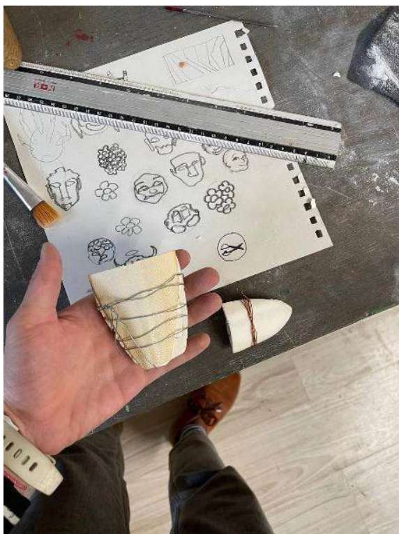
Obrázok 3 Príprava sépiovej kosti na odlievanie
