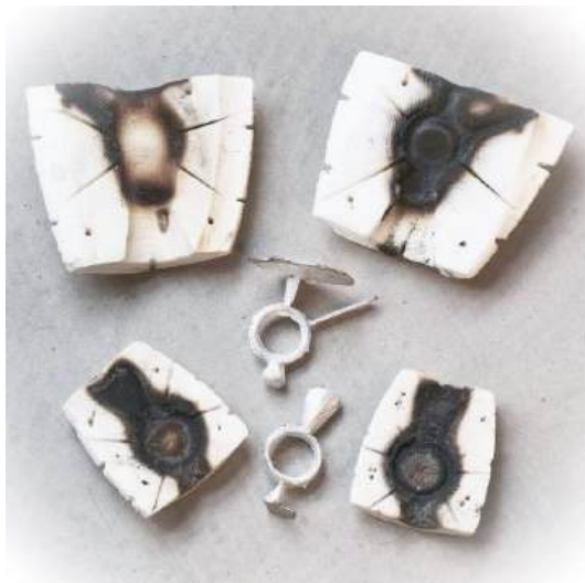
Obrázok 7 Finálne odliatky po otvorení sépiovej kosti
